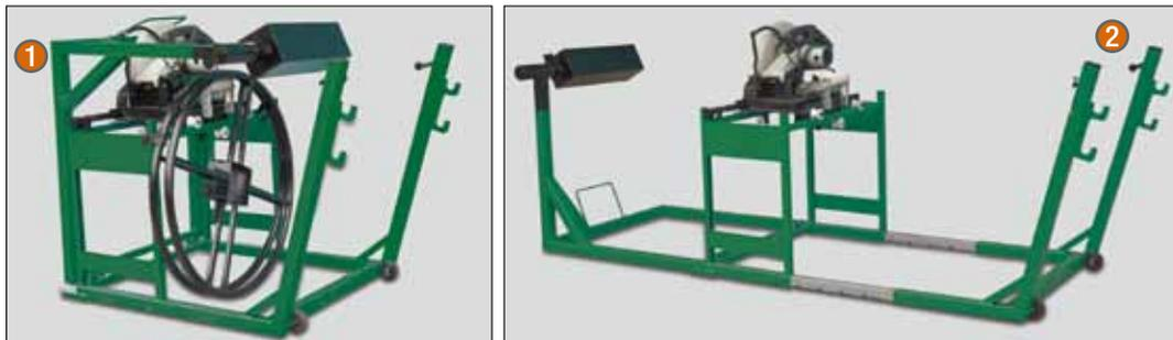
Apparecchiatura preposta per il confezionamento dei prodotti della gamma **ULTRASOLAR 2** di semplice impiego ed ideale per il taglio a misura e l'avvolgimento in rotoli di diversa lunghezza, al fine di agevolarne trasporto, magazzinaggio e gestione nei cantieri.
